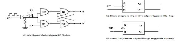
Figure: Edge triggered RS flip-flop
