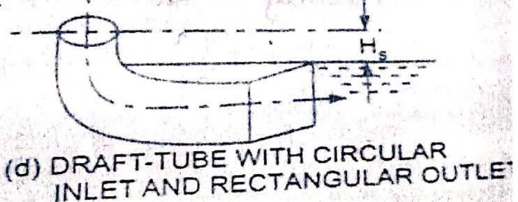
(d) DRAFT-TUBE WITH CIRCULAR INLET AND RECTANGULAR OUTLET
