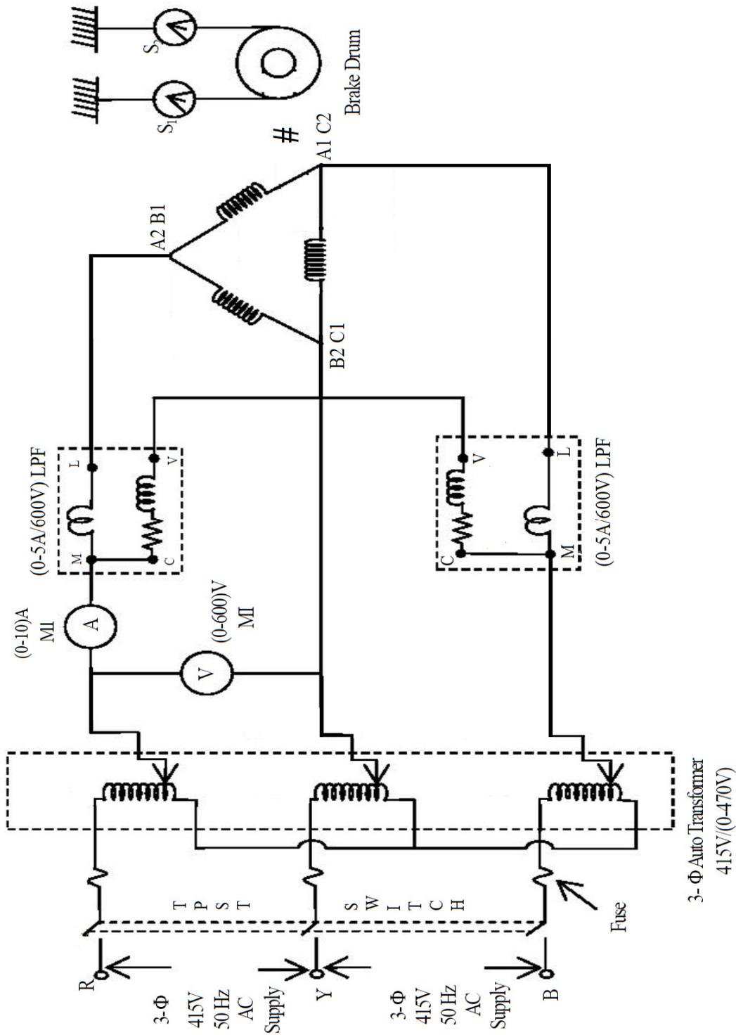
**CIRCUIT DIAGRAM FOR BLOCKED ROTOR TEST:**
